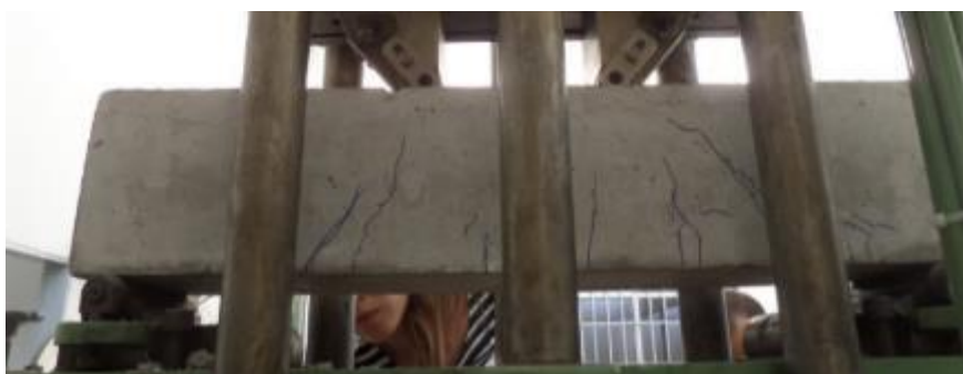
Figura 11 - Viga 2 em estado de fissuração (Autores (2017))
