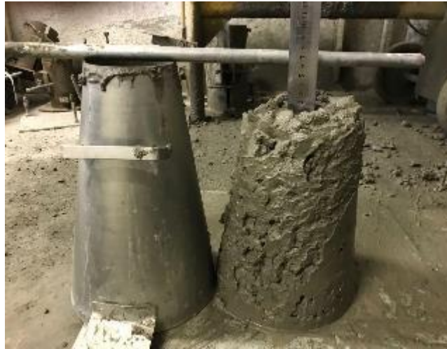
Figura 4 - Ensaio Slump Test (Autores (2017))
