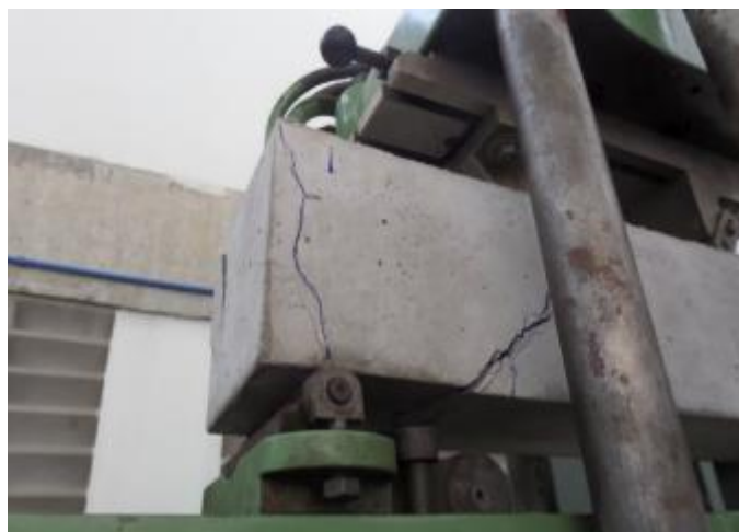
Figura 12 - Viga 2 após sofrer a ruptura (Autores (2017))
