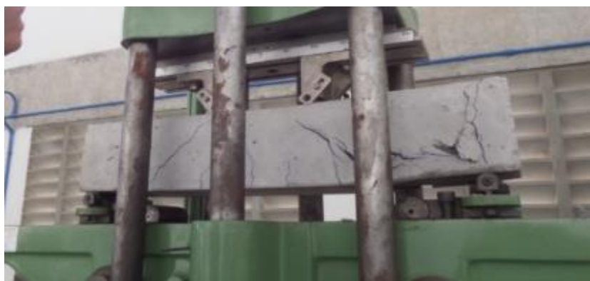
Figura 9 - Viga 1 após sua ruptura (Autores (2017))
